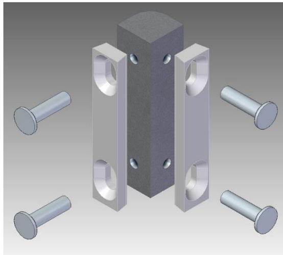
3. Lösen Sie danach die Flächenbündigen Glasaufnahmen von den Beschlügen
