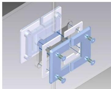
**Tipp:** Befestigen Sie das Scharnier zuerst am fest stehenden Element und danach an der Tür.
