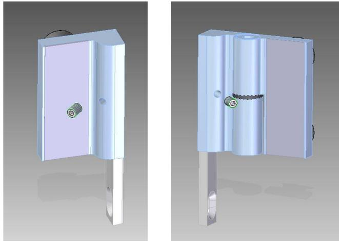
2. Befestigen Sie nun die Schwalbenschwanzplatten am Verbindungsstück.
