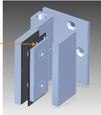
2. Lösen Sie nun die Schrauben und entfernen Sie die Platte und die Dichtung.
