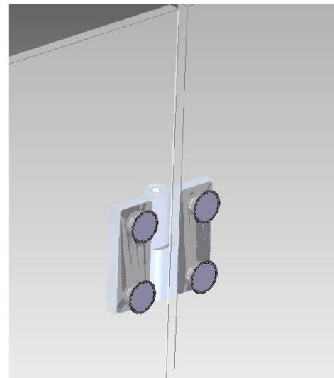
**Tipp:** Befestigen Sie erst beide Hälften des Scharniers einzeln am Glas und hängen Sie die Tür dann anschließend am Festteil ein.
