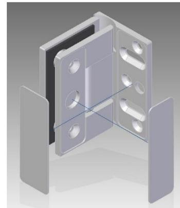
2. Lösen Sie dann die Schrauben und entfernen Sie die Abdeckungen und Dichtungen.
