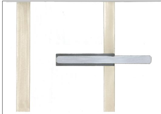
Die Siebhülse muss bündig im Bohrloch eingesetzt werden.
