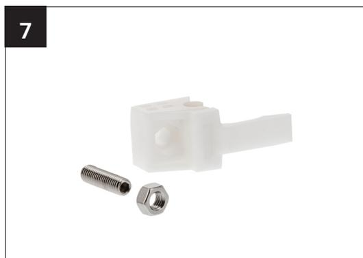
Legen Sie die beiliegende Mutter in die vorgesehene Versenkung. Schrauben Sie den Stift von unten in die Mutter. Die Spitze des Stiftes muss nach oben zeigen. Schieben Sie die Stopper je von rechts und links in die Laufschiene ein. Der Fanghaken zeigt dabei nach oben und wird in der Nut geführt.
