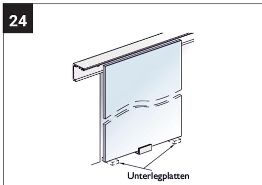
Positionieren Sie die Laufwagen. Stellen Sie dann die Glastür unten in die Bodenführung und richten das Glas gerade aus. Oben führen Sie den Steg des Laufwagens in den Glasausschnitt.
