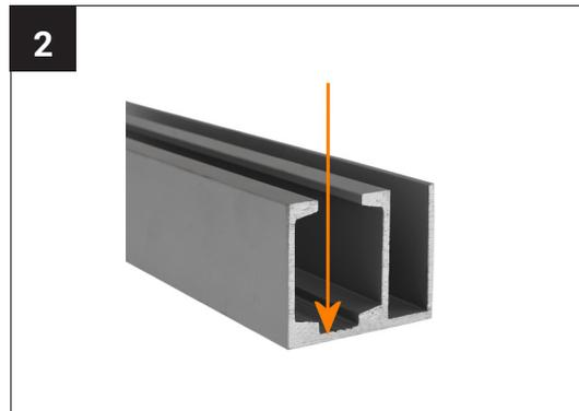
Die Laufschiene hat eine vorgesenkte Nut. Bohren Sie die benötigten Befestigungspunkte mit einem Metallbohrer durch. Bei Bedarf können Sie diese nachsenken.
