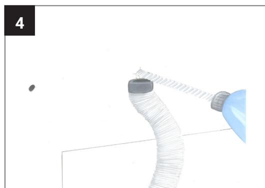
Bohren Sie nun die Löcher in die Decke und saugen dabei den Bohrstaub ab.
