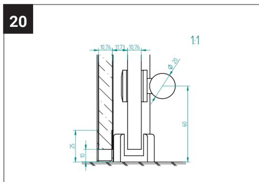
Bevor Sie die Bodenführung montieren, prüfen Sie die Glasstärke der Schiebetür. Die Bodenführung ist für Glasstärken von 8 bis 10,76 mm einstellbar.
