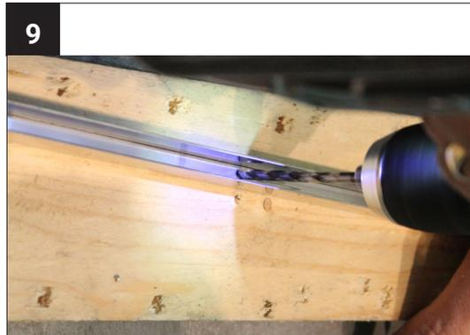
Bohren Sie das Profil mit dem Metallbohrer vor. Empfohlene Bohrlochabstände liegen zwischen 200 bis 300 mm. Achten Sie darauf, dass sich oben und unten ein Bohrloch je nahe am Profilstende befindet.
