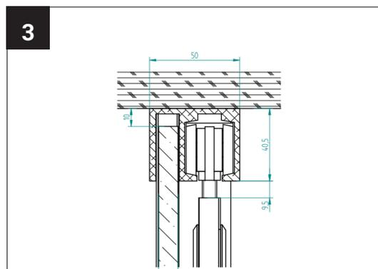
Ermitteln Sie die korrekte Position der Laufschiene an der Decke. Richten Sie die Laufschiene gerade aus und zeichnen die Löcher ein.
