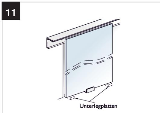
Heben Sie die Glastür schräg von unten in die Führungsschiene und richten Sie diese vorsichtig auf, bis sie lotgerecht auf der Bodenschiene steht.
