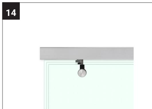
Mit der Höheneinstellschraube am Laufwagen kann nun die Glastür angehoben werden, um die Unterlegkeile zu entfernen. Zudem kann nun die Glastür, wenn nötig, ausgerichtet werden.
