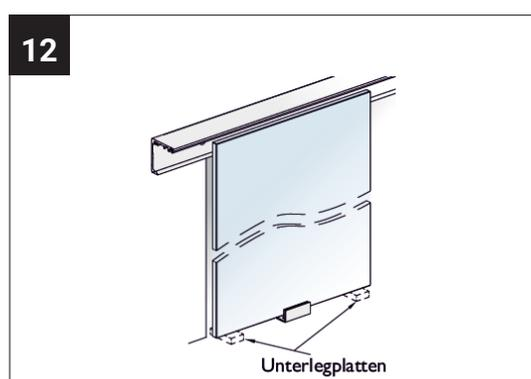
Positionieren Sie die Laufwagen. Stellen Sie dann die Glastür unten auf die Bodenschiene. Oben führen Sie den Steg des Laufwagens in den Glasausschnitt.
