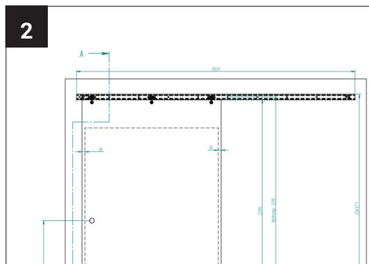
Ermitteln Sie die korrekte Position der Laufschiene an der Wand / Decke. Richten Sie die Laufschiene mit Hilfe einer Wasserwaage gerade aus und zeichnen die Löcher ein.
