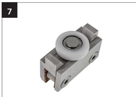
Schrauben Sie die Seitenplatte mit dem Innensechskant ab. Setzen Sie den Führungswagen auf die Glasbohrungen Ihrer Schiebetür. Schrauben Sie die Seitenplatte dann wieder an.
