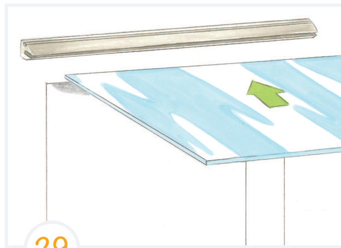
Glas bis zur Endlage einschieben und an den Profilkanten bündig ausrichten
