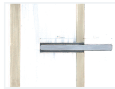
normales Mauerwerk Siebhülse bündig, Gewindestange mit 2K-Kleber einkleben
