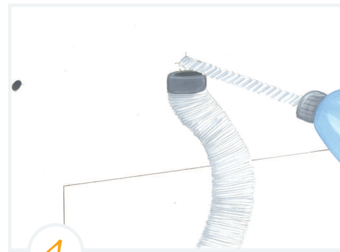
Bohrmaschine mit 16er Bohrer vorbereiten. Bohren und absaugen.
