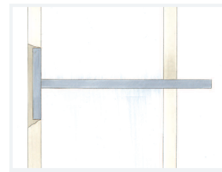
Porenbeton Gewindestange von innen mit 70er Tellern kontern
