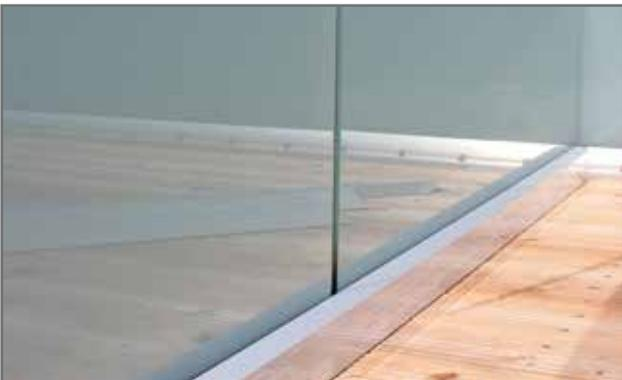
Das System Perviento ist ein freitragender Windschutz, der ohne Stützen oder Mittelpfosten konstruiert ist. In dem robusten Bodenklemmprofil wird das Glas sicher eingespannt, so dass eine Windschutzhöhe bis 250 cm realisiert werden kann. Durch einen Kantenschutz auf der Oberkante des Glases wird der Windschutz zusätzlich stabilisiert.
