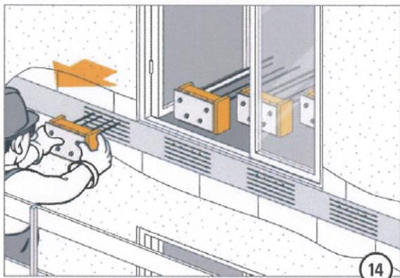
Nach der Kontrolle der Lage des Isokorbes wird der Isokorb wieder ausgebaut.
