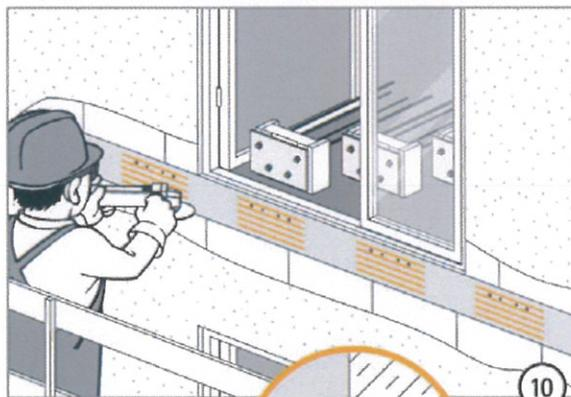
Im Bereich des Isokorbes muss die Stirnseite der Bestandsdecke entsprechend nebenstehender Skizze bzw. nach DIN 1045-1 bearbeitet werden.
