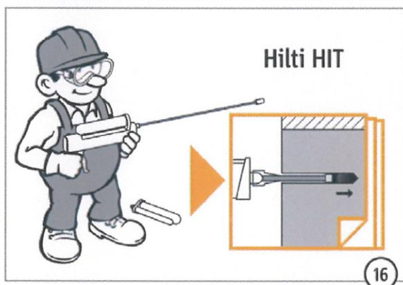
Das Bohrloch muss luftblasenfrei mit Injektionsmörtel Hilti HIT-RE 500 nach den technischen Anweisungen der ETA-08/0105 und Z-21.8-1790 verfüllt werden.
