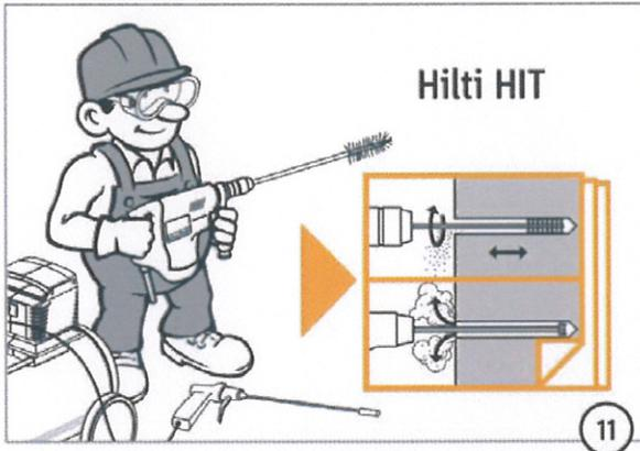
Entsprechend den technischen Anweisungen der ETA-08/0105 und Z-21.8-1790 muss jedes Bohrloch gereinigt werden.
