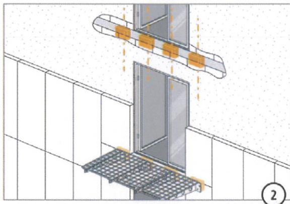
Der Schöck Isokorbanschluß ist ingenieurmäßig zu planen und auf Konstruktionszeichnungen zu dokumentieren.
