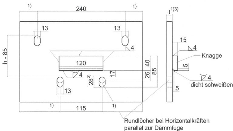
Abb. 23 Bauseitige Stirnplatte zu Schöck Isokorb Typ RKS10
