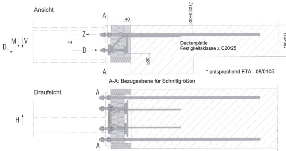
Abb. 16 und 17: Schöck Isokorb Typ RKS10 und RKS14 , Schnittgrößendefinition
