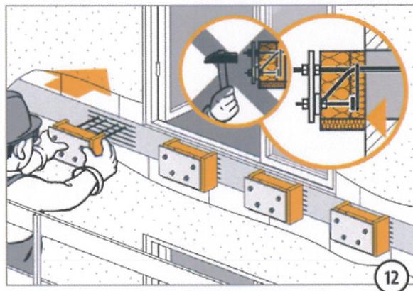
Nach der Bohrlochreinigung erfolgt der trockene Einbau des Isokorbes zu Kontrollzwecken. Der Isokorb muss ohne großen mechanischen Kraftaufwand einsetzbar sein.
