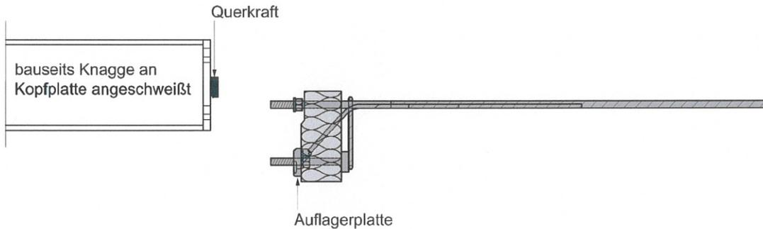
Abb. 21 Querkraftübertragung durch Knagge
