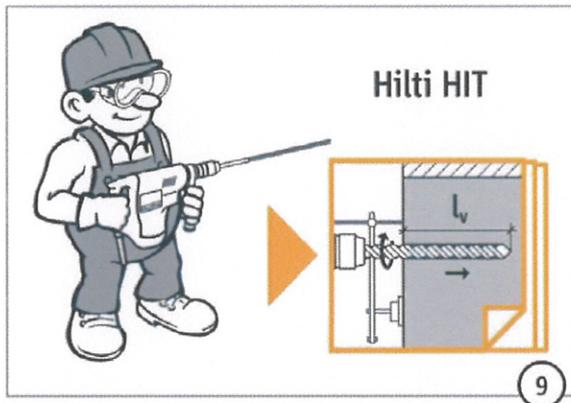
Die Bohrung muss mit dem Hammerbohrverfahren mit Bohrhilfe nach den Setzanweisungen der ETA-08/105 durchgeführt werden.
