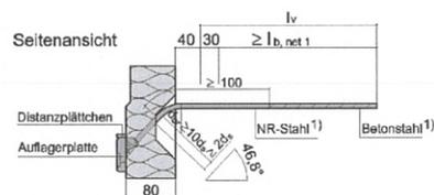
Abb. 7a bis 7b: Querkraftstäbe 2 Ø d\_s inkl. Auflagerplatte
