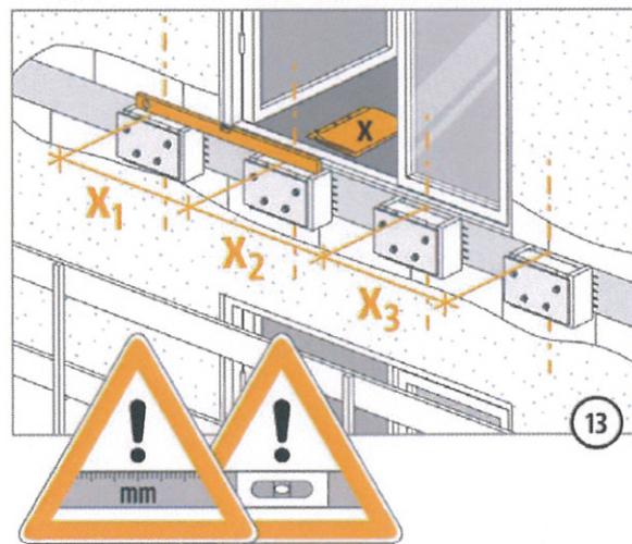
Die Lage aller Isokörbe einer Balkonplatte muss kontrolliert werden.
